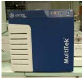
Determinador de azufre mediante fluorescencia, que determina bajas concentraciones del químico.
