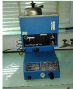
Determinador de residuo de microcarbón en gasoil, con capacidad de hacer 10 muestras en forma simultánea.
