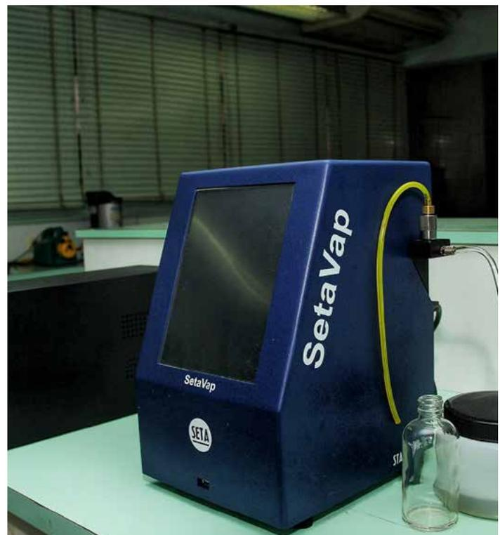
con agitador integrado para mediciones de este tipo de muestras, ASTM D6378 (triple método de expansión) para la determinación de la presión de vapor VPX y ASTM D6299 para la aplicación de técnicas estadísticas de garantía de calidad y control de la creación de gráficos para evaluar el rendimiento analítico del sistema de medición. Marca: Stanhope-seta Procedencia: Inglaterra
